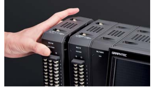
Le module est fixé par une vis
